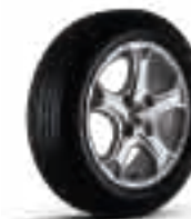
ล้ออัลลอยขนาด 6J x 15" ขนาดยาง 195/55 R15 (ในรุ่น 1.6LUX)
