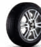
ล้ออัลลอยขนาด 6J x 15" ขนาดยาง 195/55 R15 (ในรุ่น 1.6LT A/T, M/T)
